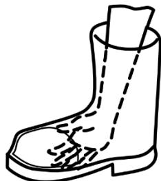
f) Destruição do forro, bordas afiadas
