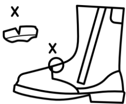
a) Duboke pukotine gornjišta
