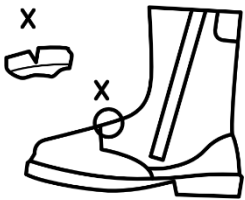
a) Глибокі тріщини на верхній частині
