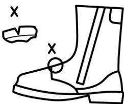
a) Tiefe Risse des Oberteils
