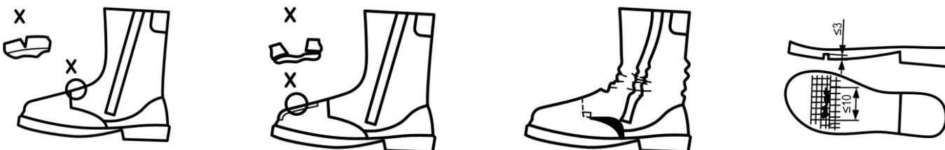
а) Глубокие трещины на верхней части б) Сильный износ верхней части в) Отделение верхнего материала г) Трещины на подошве
