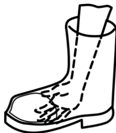
f) Destruksjon av såle, skarpe ytterkanter
