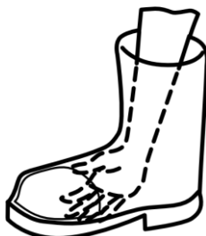
f) Destruktion des Innenfutters, scharfe Kanten
