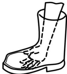
f) Deterioramento della fodera, bordi taglienti
