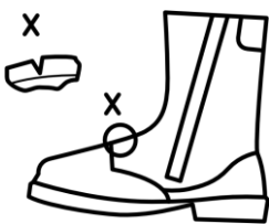
a) Dype sprekker i overdelen
