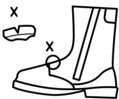
a) Djupa sprickor i ovandelen
